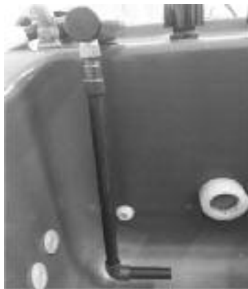
Figure 4 : Canne d'imprégnation conçue par l'Institut du thermalisme sur pilote
